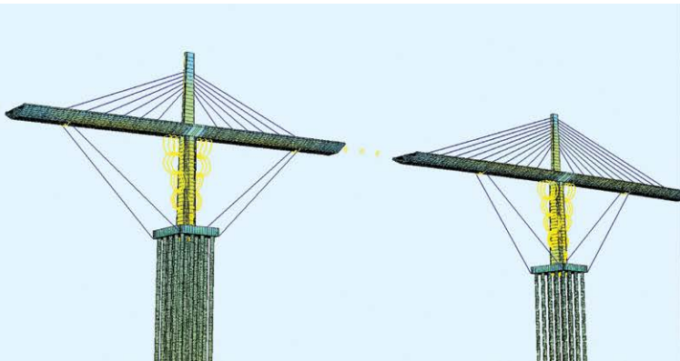
— Konzolna izgradnja ovješnog mosta
