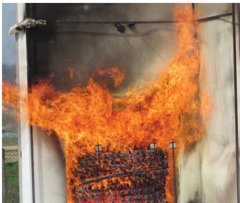
Ispitivanje otpornosti fasada na požar
